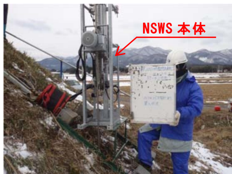
図-3 自動サウンディング試験 (NSWS) 調査機器の概要
