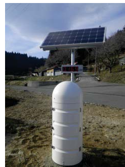
(リアルタイム線量測定システム)
