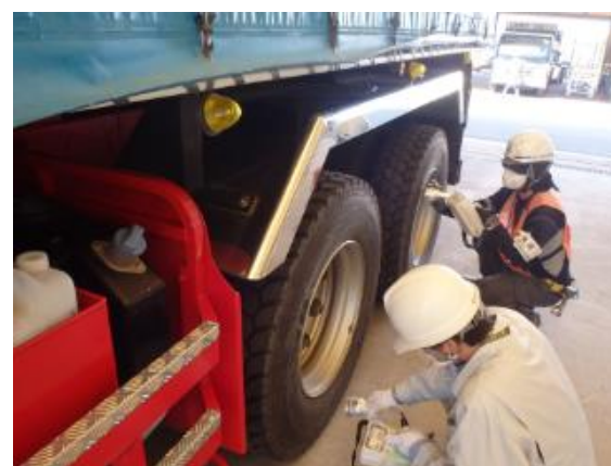
保管場からの退場車両の線量率測定
