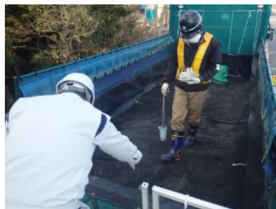
保管場からの退場車両の線量測定
