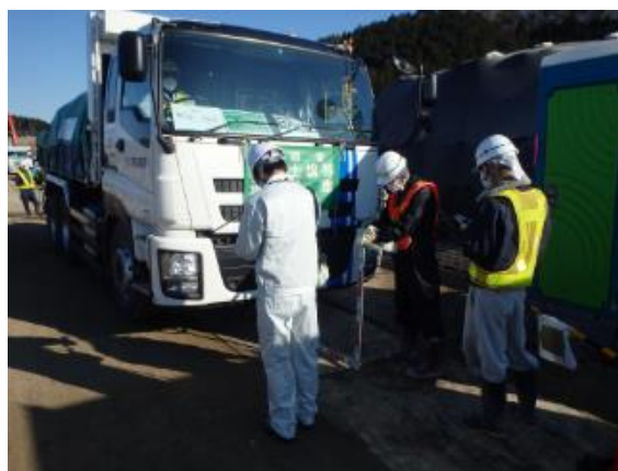
輸送車両の空間線量率確認
