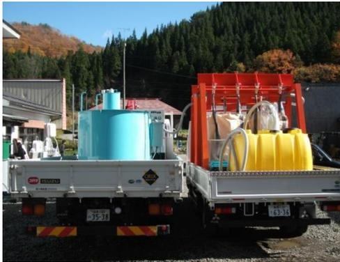
写真2 汚泥脱水処理の装置群
