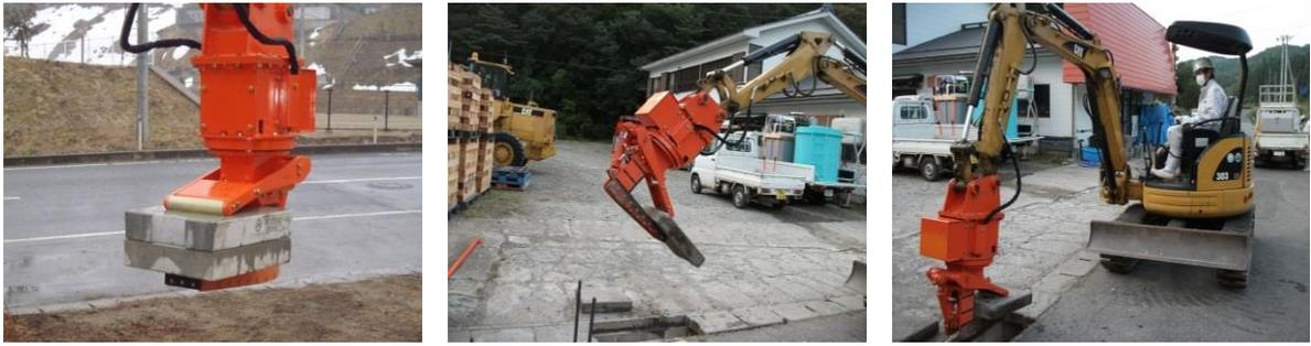
写真1 側溝蓋脱着装置
