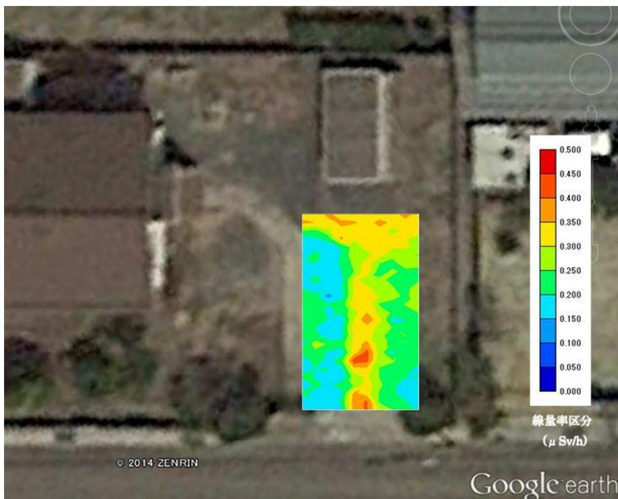
図21 P-Scannerによる二次元分布測定結果（コンター図左側の水色の部分がコンクリート部）
