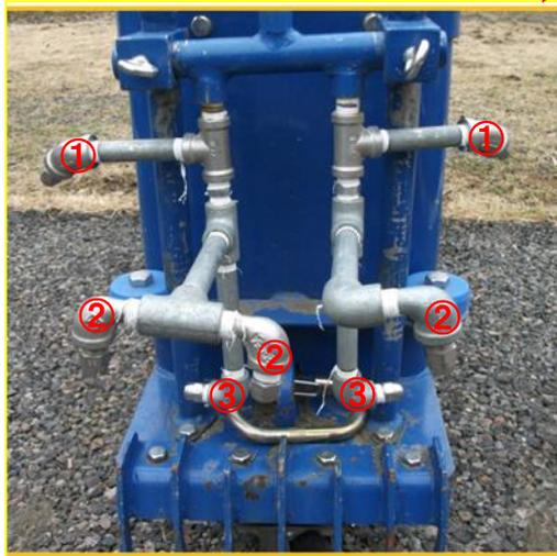
▲装置全面部の高圧洗浄水射出口
