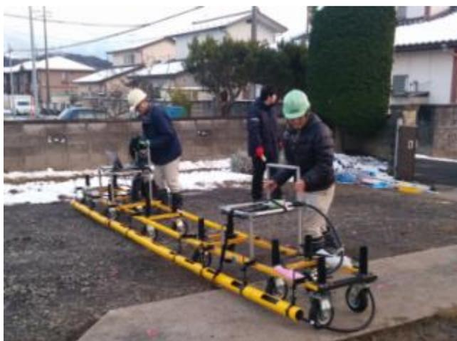
写真6 P-Scannerによる二次元分布測定
