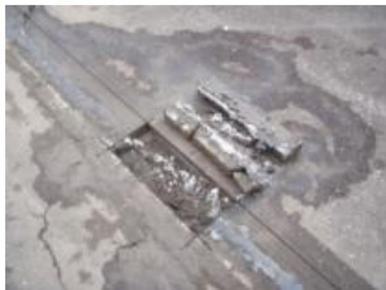
写真11 舗装材料の採取
