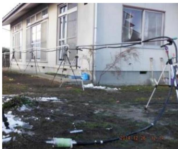
写真4 P-Scanner による測定の様子 (1m 高さ測定、実証作業時)
