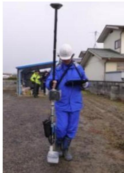
写真 2 iPLUS HotSpotFinder による測定の様子 (実証作業時)
