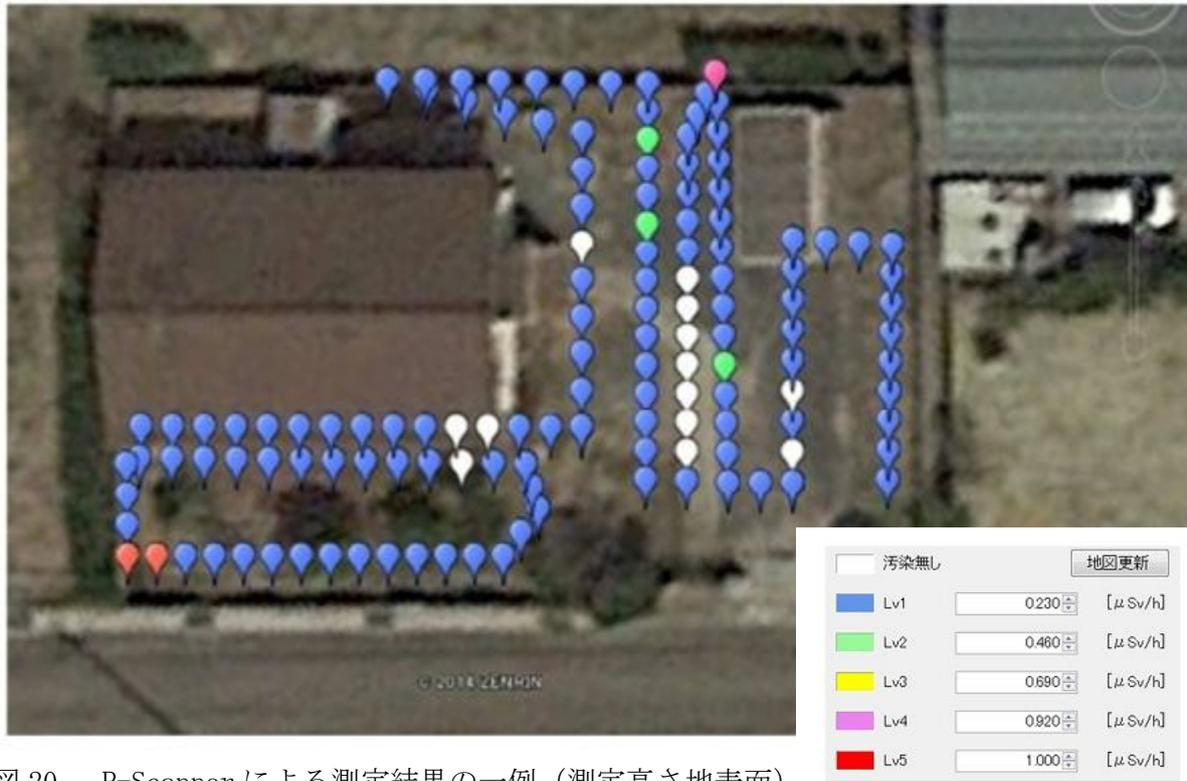
図 20 P-Scanner による測定結果の一例（測定高さ地表面）
