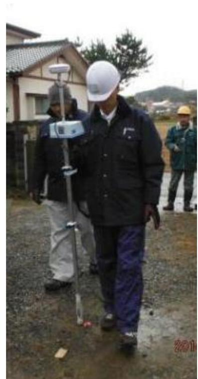
写真1 ガンマプロッターHによる測定の様子 (実証作業時)
