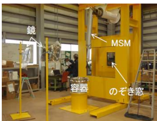
収納缶蓋閉め遠隔操作性確認試験状況
