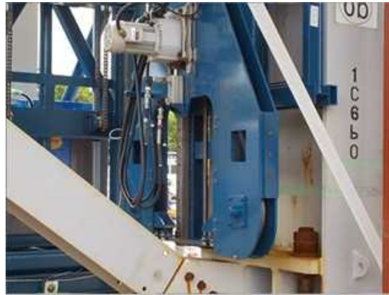
バンドソーによる切断
