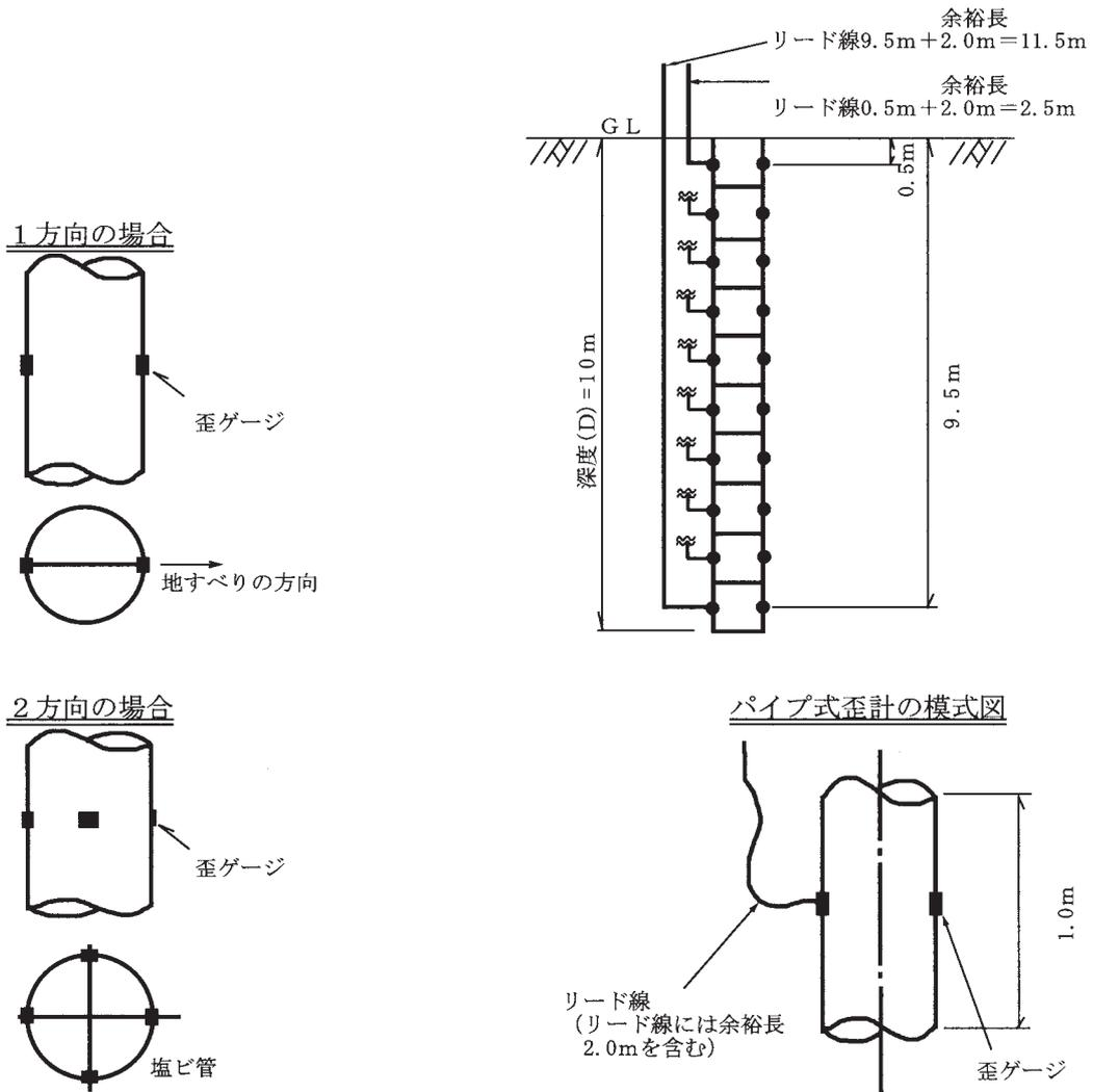
図 2 - 6 - 1 パイプ式歪計設置図
