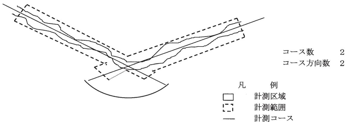
図 2 - 6 - 5 路線計測計画例 1
