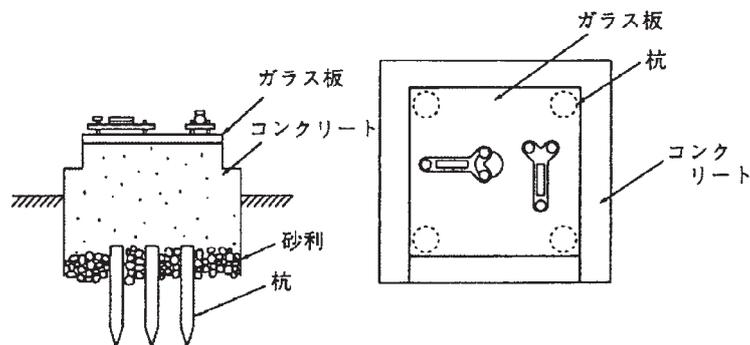
図2 - 6 - 4 傾斜計模式図
