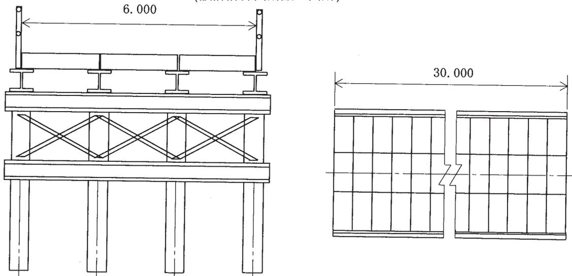
[基本構造物，工事用仮橋，幅員4m・6m，橋長30m]
