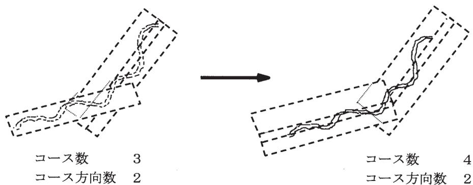
図 2 - 6 - 6 路線計測計画例 2
