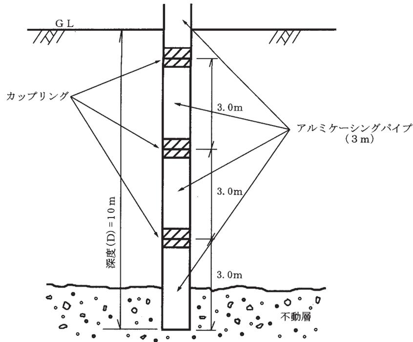
図 2 - 6 - 2 挿入式孔内傾斜計設置図
