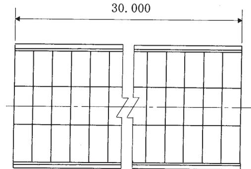
[類似構造物，工事用仮橋，幅員4m，橋長30m]
