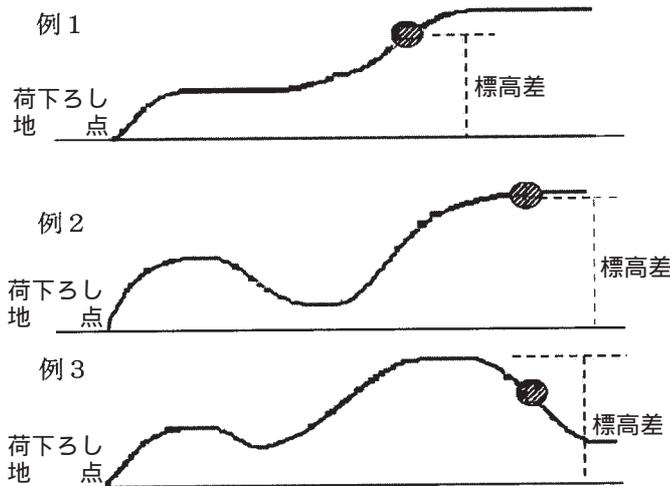
人肩運搬もしくは特装車で現場内小運搬を行う場合の「換算距離」における標高差は、図に示すとおり荷下ろし地点からボーリング地点までのルート上での最大の標高差とする。
