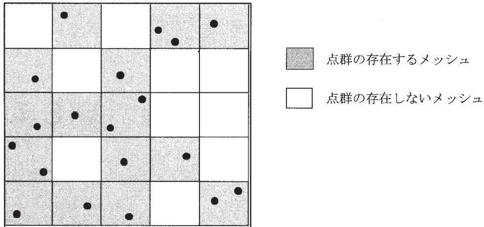
図 2 - 6 - 7 計測密度の点検方法
