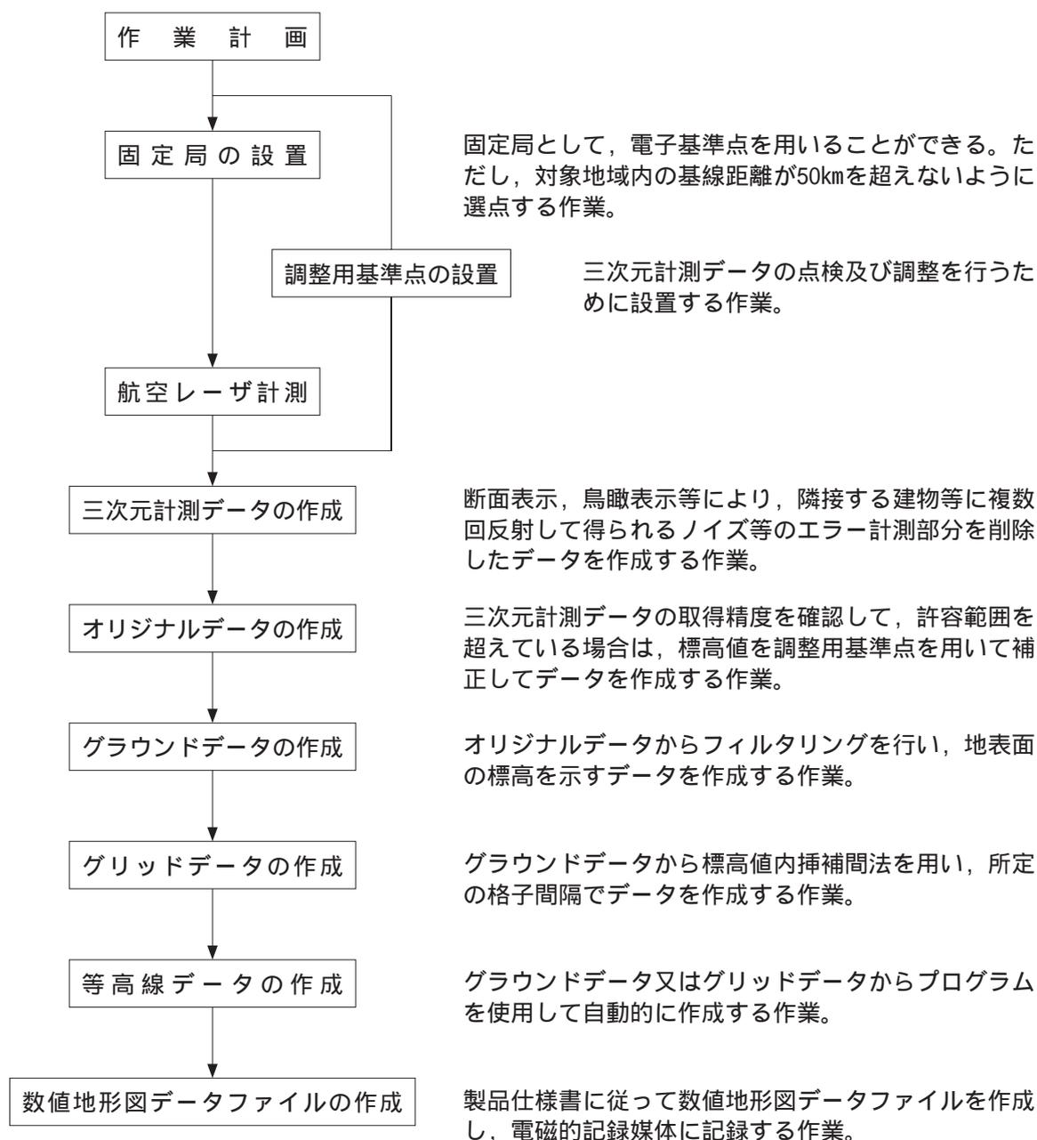
図 2 - 6 - 1 航空レーザ測量フローチャート
