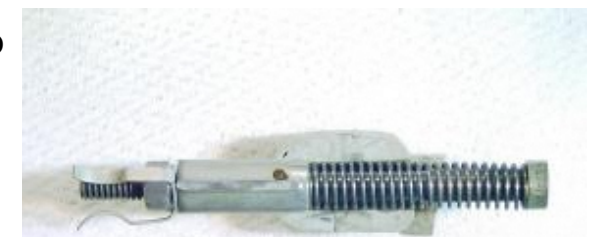
上部タイプレートの孔食の例 (90°C, Cl - 濃度:2500ppm, 2000時間,上部端栓は照射材)
