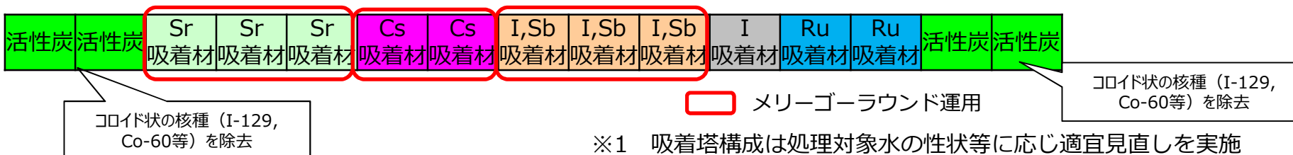
(参考) 吸着材の交換・運用 (メリーゴーラウンド運用) イメージ(Sr吸着材を充填した吸着塔3塔の場合)
