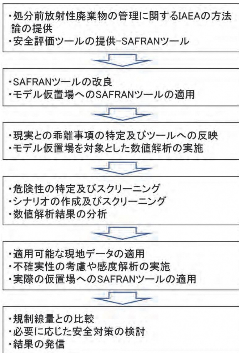
図 6.3 県内における仮置場の安全性評価実施作業の流れ
