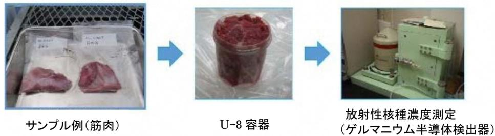
図1 野生動物における放射性核種の測定
