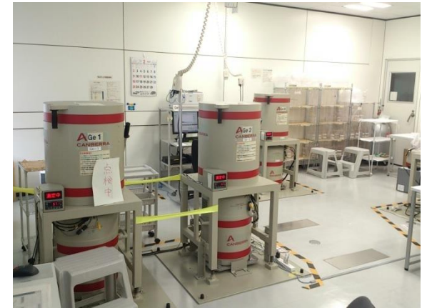
Ge半導体検出器で検査 (福島県農業総合センター検査室)
