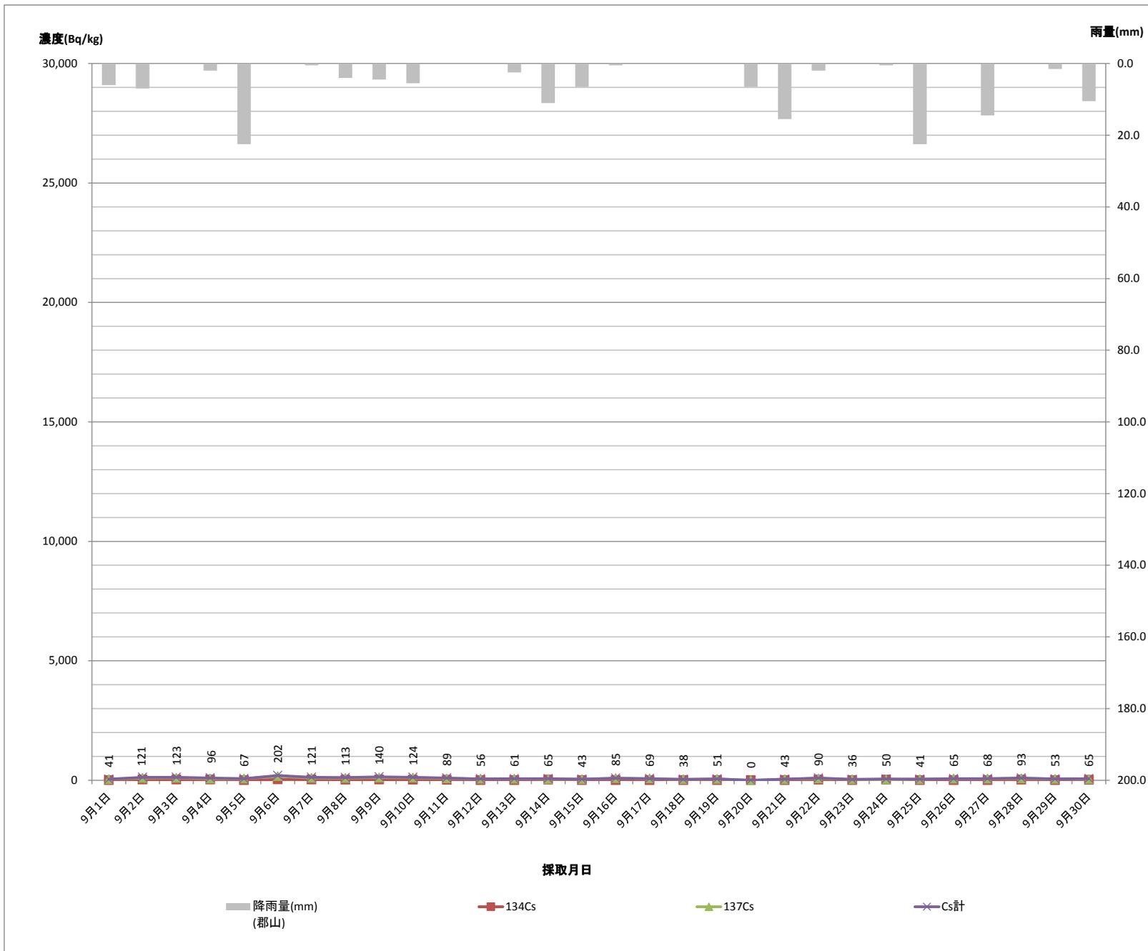
下水道終末処理場放射性物質濃度モニタリング結果（県中浄化センター）脱水汚泥（H30.10月）
