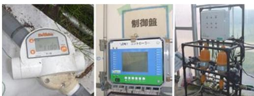
図1 かん水制御装置の例
