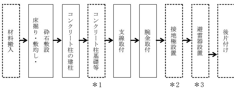
\*1 は、根入れが満足しないなど補強する場合及び鋼管ポールなどによるベースプレート式の場合とし、「第2章第1節①3-7 作業土工（電気）」による。
