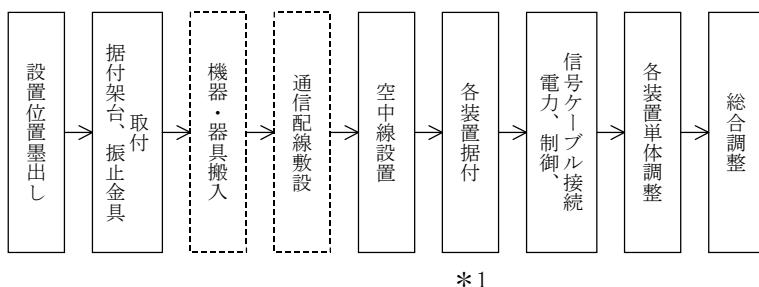
\*1は、同一室内各装置間の各種ケーブルの敷設を含む。
