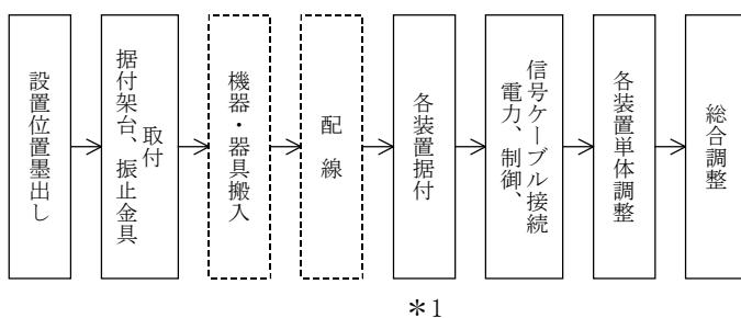
\*1は、同一室内各装置間の各種ケーブルの敷設を含む。
