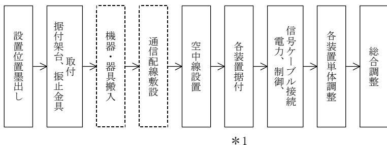
\*1は、同一室内各装置間の各種ケーブルの敷設を含む。
