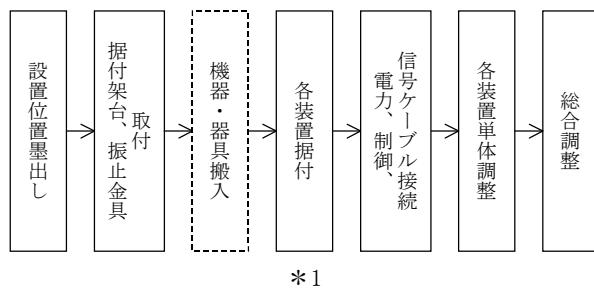
\*1 は、同一室内各装置間の各種ケーブルの敷設を含む。
