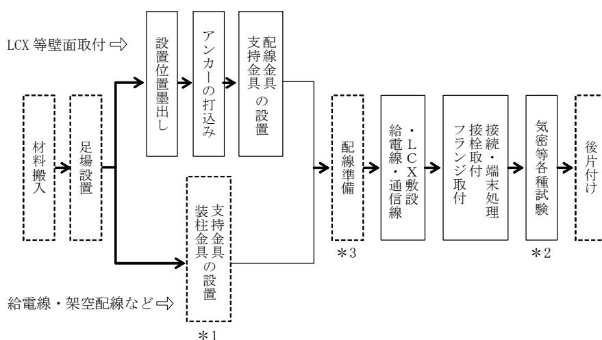
\*1 は、架空配線については、「第2章第1節⑧引込柱設置工（腕金取付）」による。
