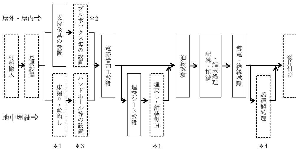
\*1は、「第2章第1節①3-7 作業土工（電気）」による。なお、床掘時に舗装があればとりこわしを計上する。
