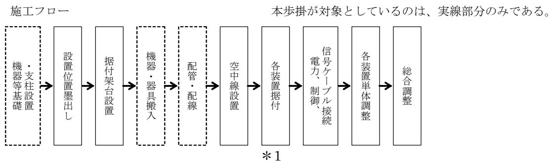
\*1 は、同一室内各装置間の各種ケーブルの敷設を含む。
