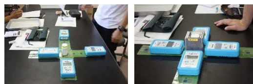
図 6 左：距離による線量の変化の実験（はかるくんを線源から 5, 10, 15, 20 cm ずつ離して計測）、右：壁による遮蔽効果の実験（遮へい材セットで線源を囲んで計測）
