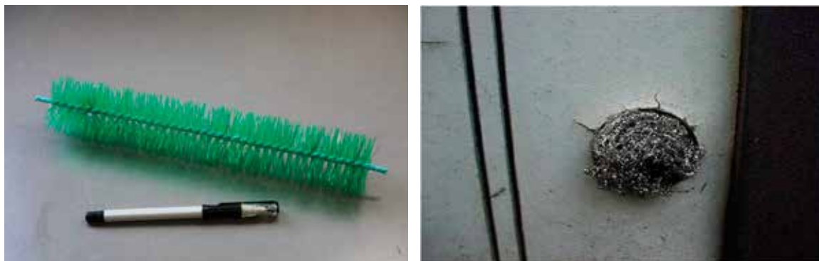
写真 20 防鼠ブラシ（左）金属タワシによる侵入防止（右）
