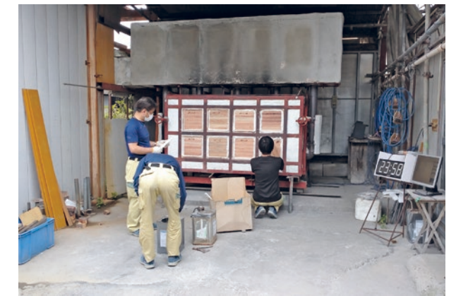
木材と塗料による耐火性能試験(要素試験)の様子
