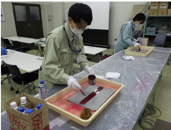
浸透探傷試験（赤色や蛍光の浸透性の良い検査液を用いて、金属表面の割れや傷を検出するための非破壊検査方法）の実習
