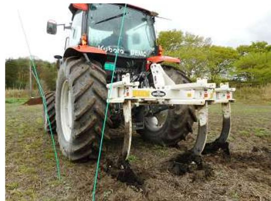
図15 リッパー装着時のトラクタ
