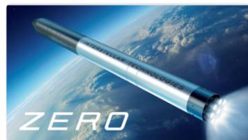
地球周回軌道上に超小型衛星を運ぶ2段式ロケットで、低い軌道傾斜角から極軌道まで自由な軌道が選択可能
