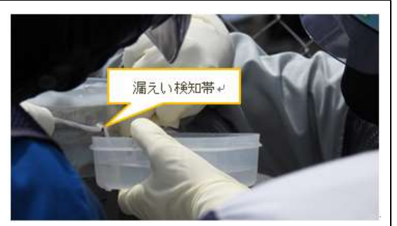
(写真2-3) 漏えい検査の状況 漏えい検知帯を水に接触させている様子
