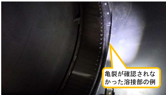
(写真3) ロータリーキルン（B系）の状況 ※ロータリーキルン下部方向から撮 影
