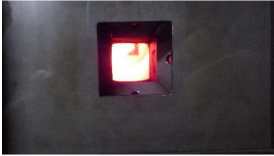
(写真1) 焼却炉（B系）のロータリーキルン での廃棄物の燃焼の状況
