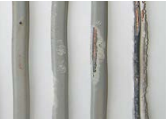
写真3 ネズミにかじられた 電気ケーブル
