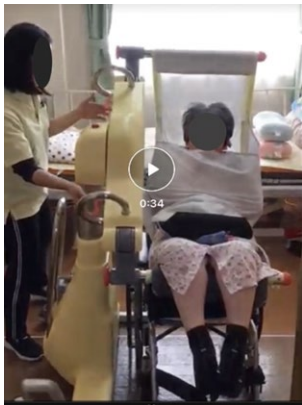
介護ロボットを用いて移乗支援をしている様子 職員1名（左）、利用者1名（右）
