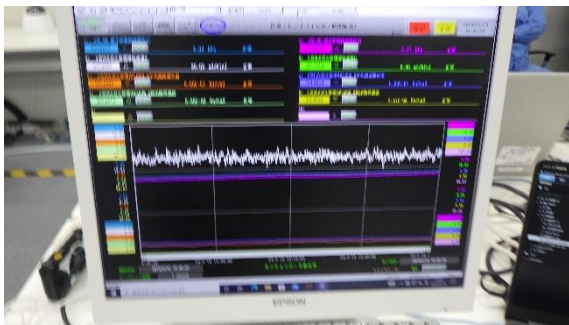
(写真5) ダスト等監視用ディスプレイ (高圧水噴射後)
