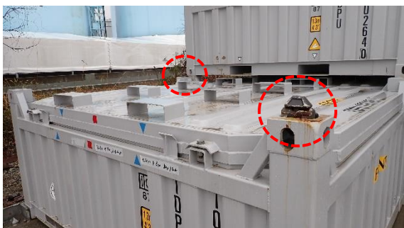
(写真6) コンテナ四隅の対角線上に設置された 固定金具
