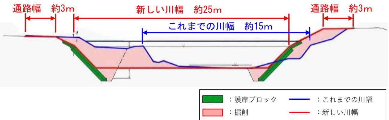
再度災害がないよう河幅を拡大しており、必要な流下断面は確保しています。
