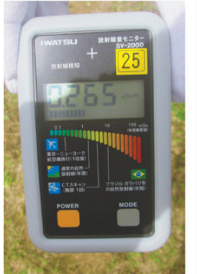
除去土壌の上で実際に測定した放射線量
