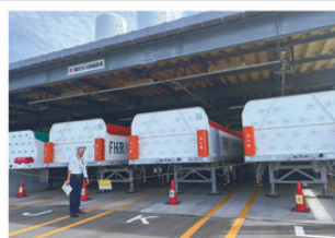
FH2Rで製造した水素を遠くまで運ぶ水素ガストレーラー
