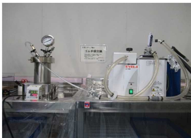
コールドトラップにより水を回収
