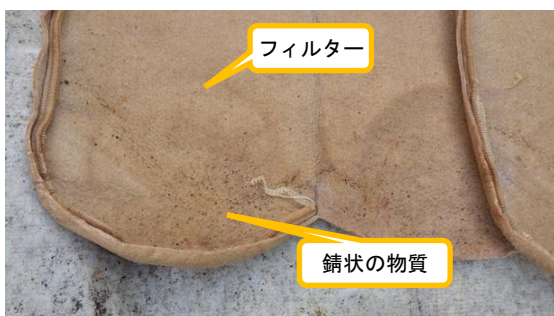
(写真 3) フィルター内側に捕捉された錆状の物質
