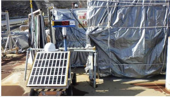
(写真 5－1) リアルタイム線量計設置状況①（南側、 9.8 \mu\text{Sv/h} ）
