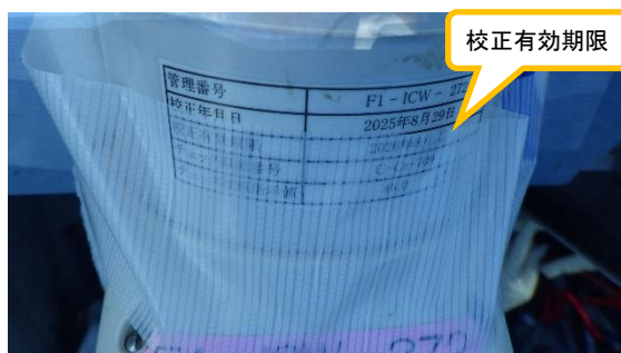
(写真 2) 線量計の状況 (校正有効期限：2026年8月迄)
