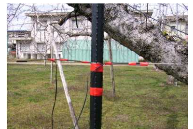
図2 温度センサーの設置方法
