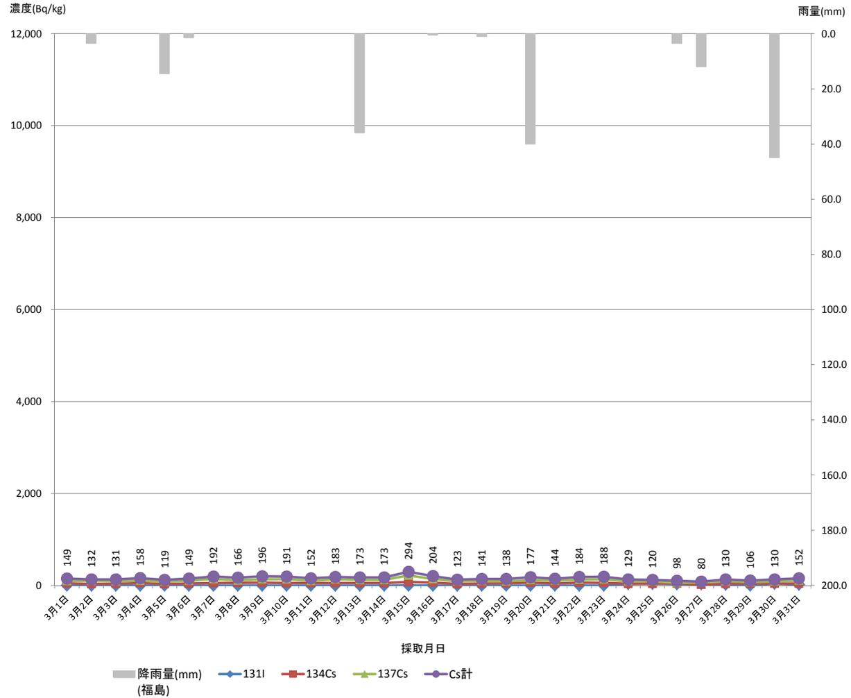
下水道終末処理場放射性物質濃度モニタリング結果（県北浄化センター） 脱水汚泥（H26.4月）
