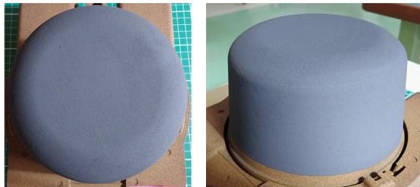
図2 ロボットにより仕上げた<sup>とがた</sup>塗型
