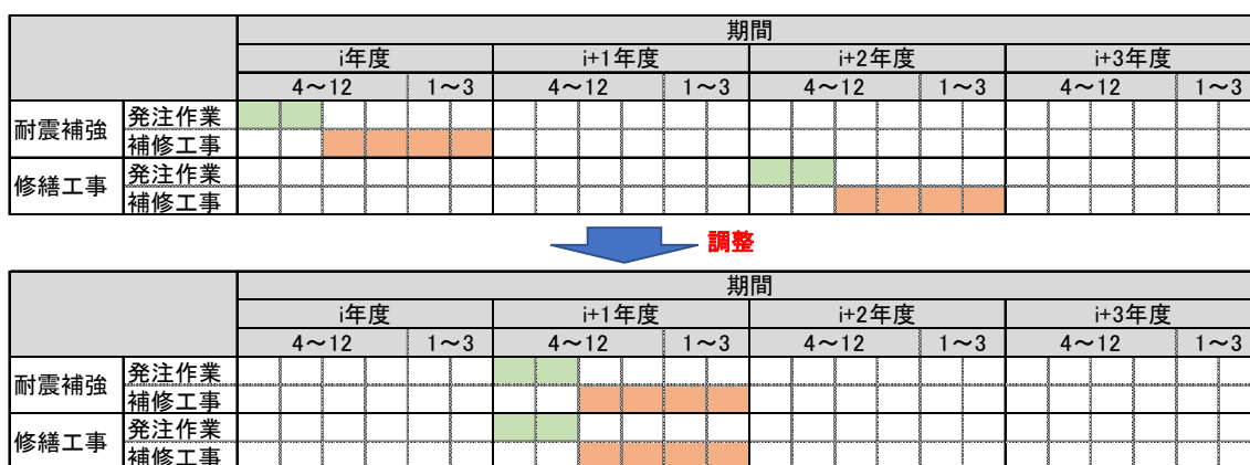
図 4.8 修繕工事と耐震補強の同時施工
