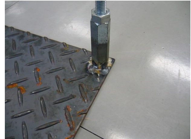
鉄板とナットのスポット溶接
