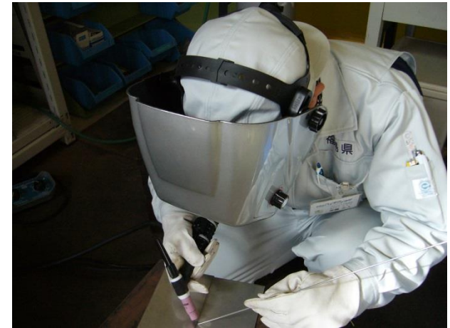
ステンレス (SUS304) 材の突合せ溶接
