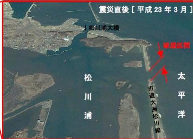
松川大洲地区海岸は東日本大震災に伴う津波の影響で海岸堤防と道路が被災し、約350m区間が決壊しました。現在、平成27年度末(平成28年3月)の完成に向けて、海岸堤防と市道の復旧を行っています。復旧状況としては、旧堤防の撤去が完了し、地盤の改良工事を行っています。地盤改良が完了次第、堤防の盛土に着手していきます。現在、松川大洲地区海岸は立入禁止となっていますが、行政機関や学生など県内外から多くの方が視察に来ています。このため、現地に広報用の看板を設置し、理解を深めてもらっています。
