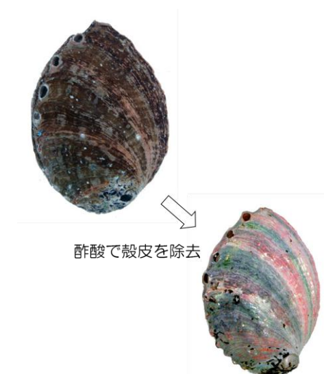
図 1 酢酸によるアワビ貝殻の処理
