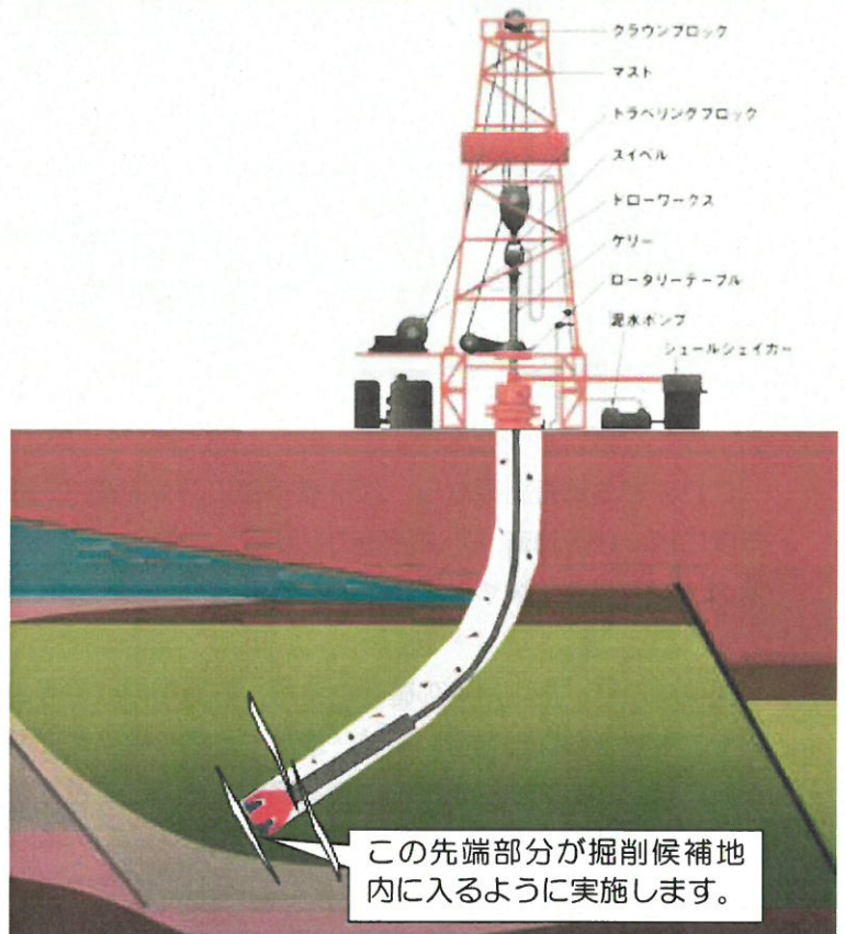
掘削工事模式図
