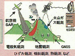
ひずみ観測、傾斜観測、熱観測など
