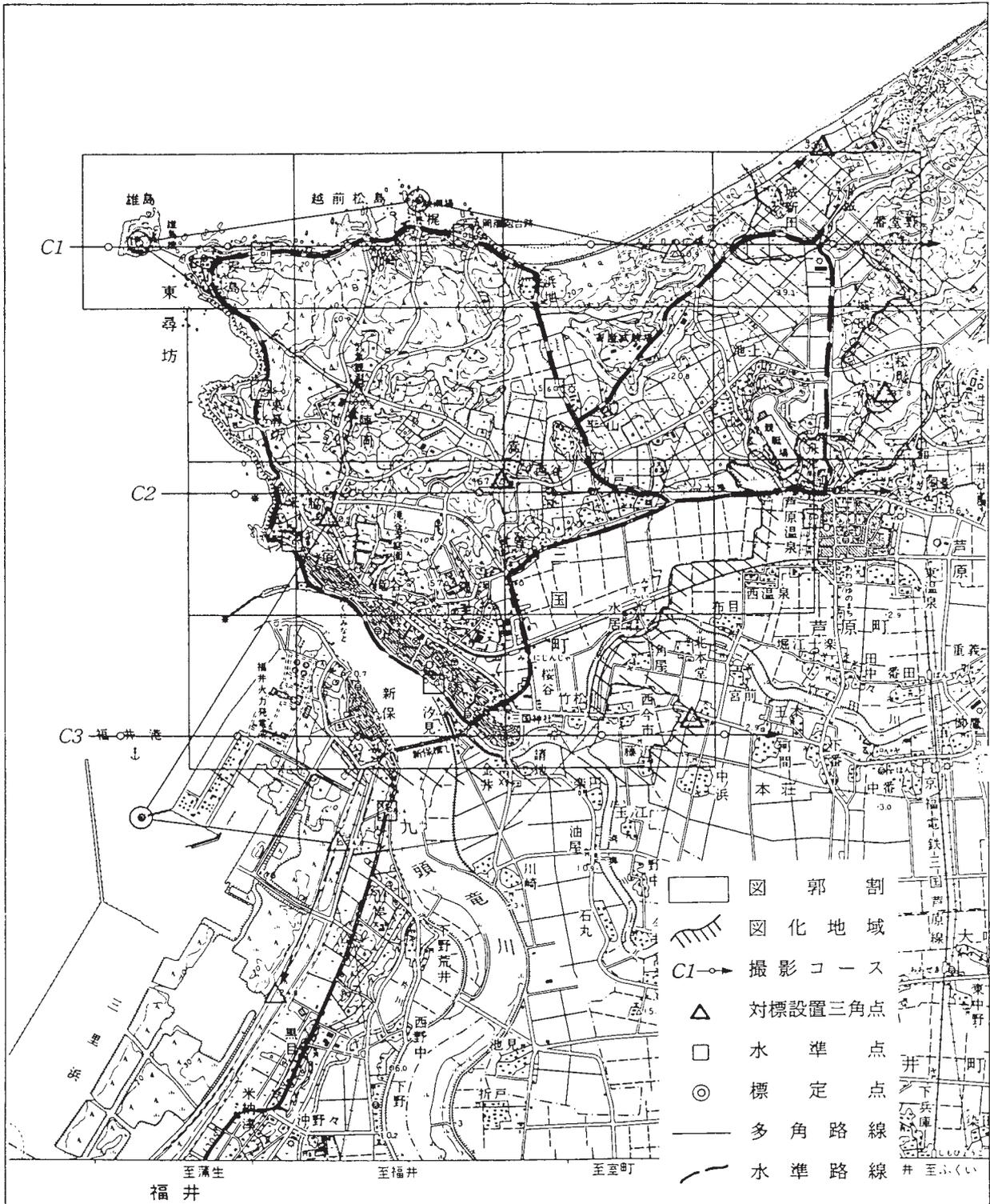
付図記載例 (2) 「基準点測量及び確認測量地域図等の場合」
