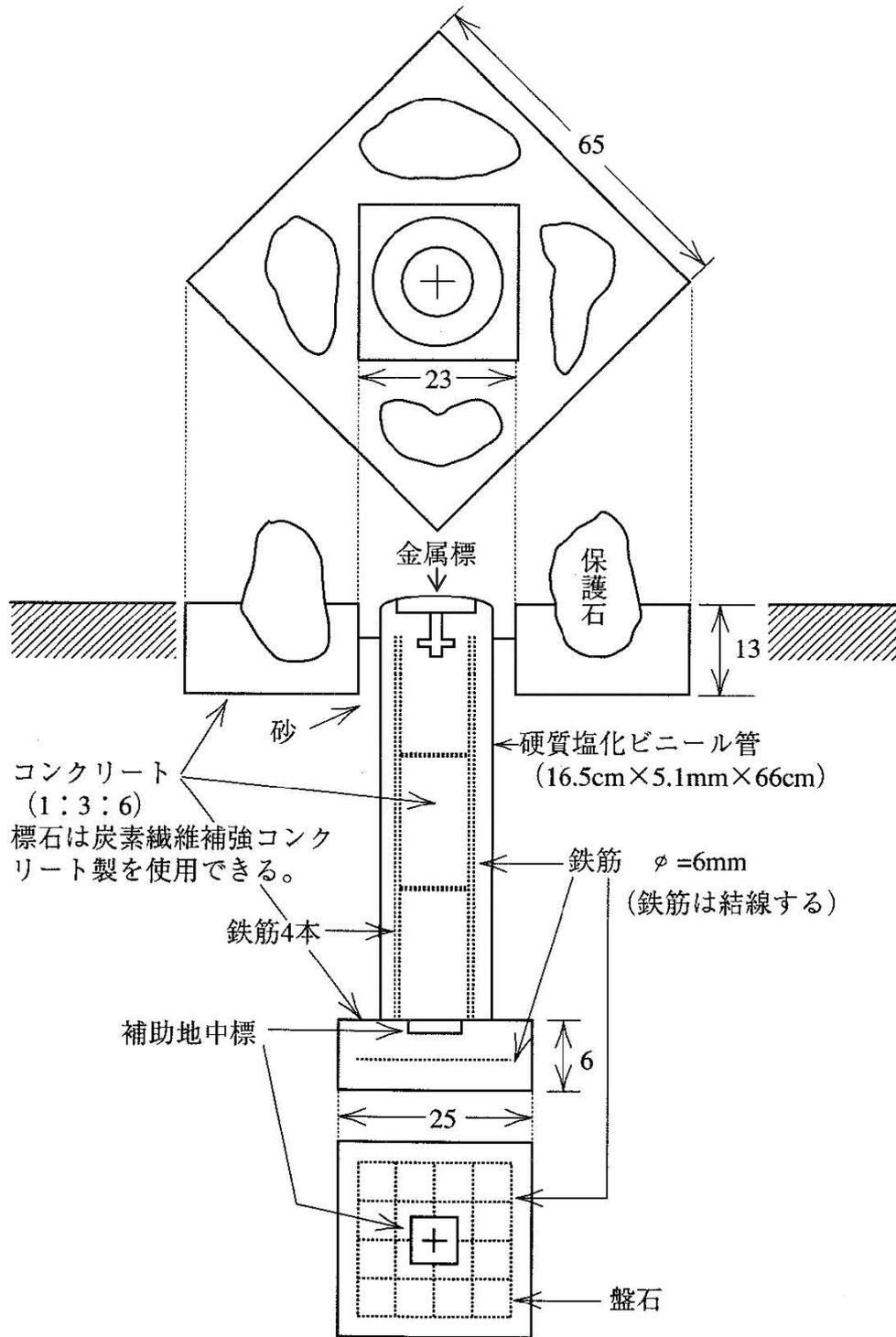
2) 基準点（金属標）地下埋設図
