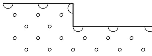
上端(太線):11、下端(細線):12、上端に付属する半円記号及び射影内部の輪形記号は自動発生
