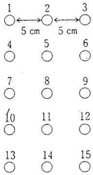
実体モデルの範囲で、端と真中に点を取る。点の配置は、格子板上で左図のようなものを標準とし、それぞれの格子板に応じて選ぶ。
