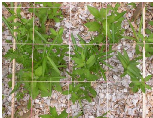
写真 - 4 植被率の算定 (格子点に植物が有る場合、植被率としてカウントする)
