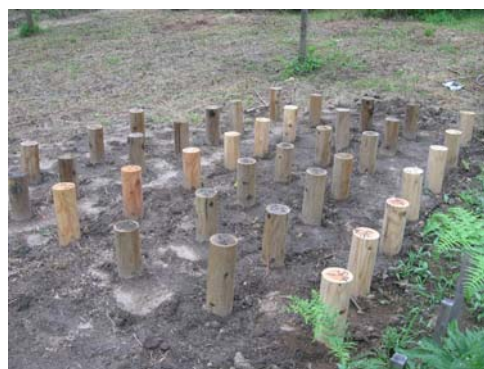
写真 - 10 処理材の野外杭耐朽試験
