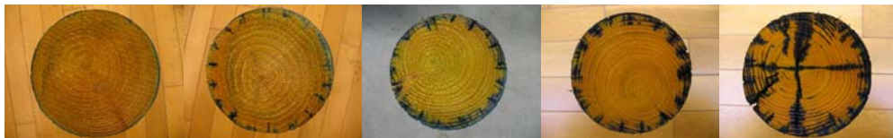
写真 - 8 防腐剤含浸状況
