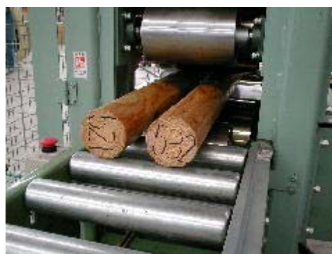
写真 - 5 ロール圧縮処理
