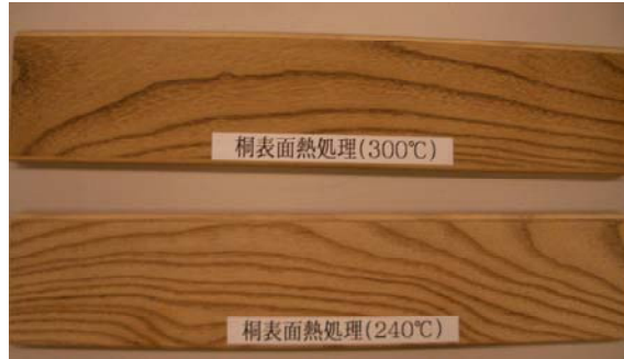
写真-6 ロール熱処理を行った桐フローリングの試作品 (上段：300℃処理、下段240℃処理)
