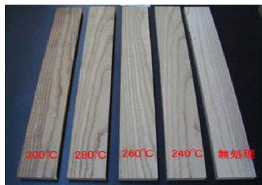
図-11 ロール熱処理前後の明度の変化 写真-5 処理温度別の表面熱処理材
