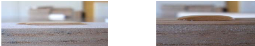
写真-7 表面熱処理材の撥水性（左無処理、右300℃処理）
