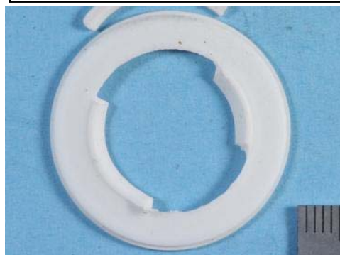
当該弁のテフロン製弁シートの欠損状況
