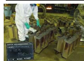
解体物放射能濃度測定状況
